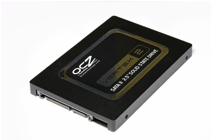
Slika 1: "klasični" SSD veličine 2.5"
